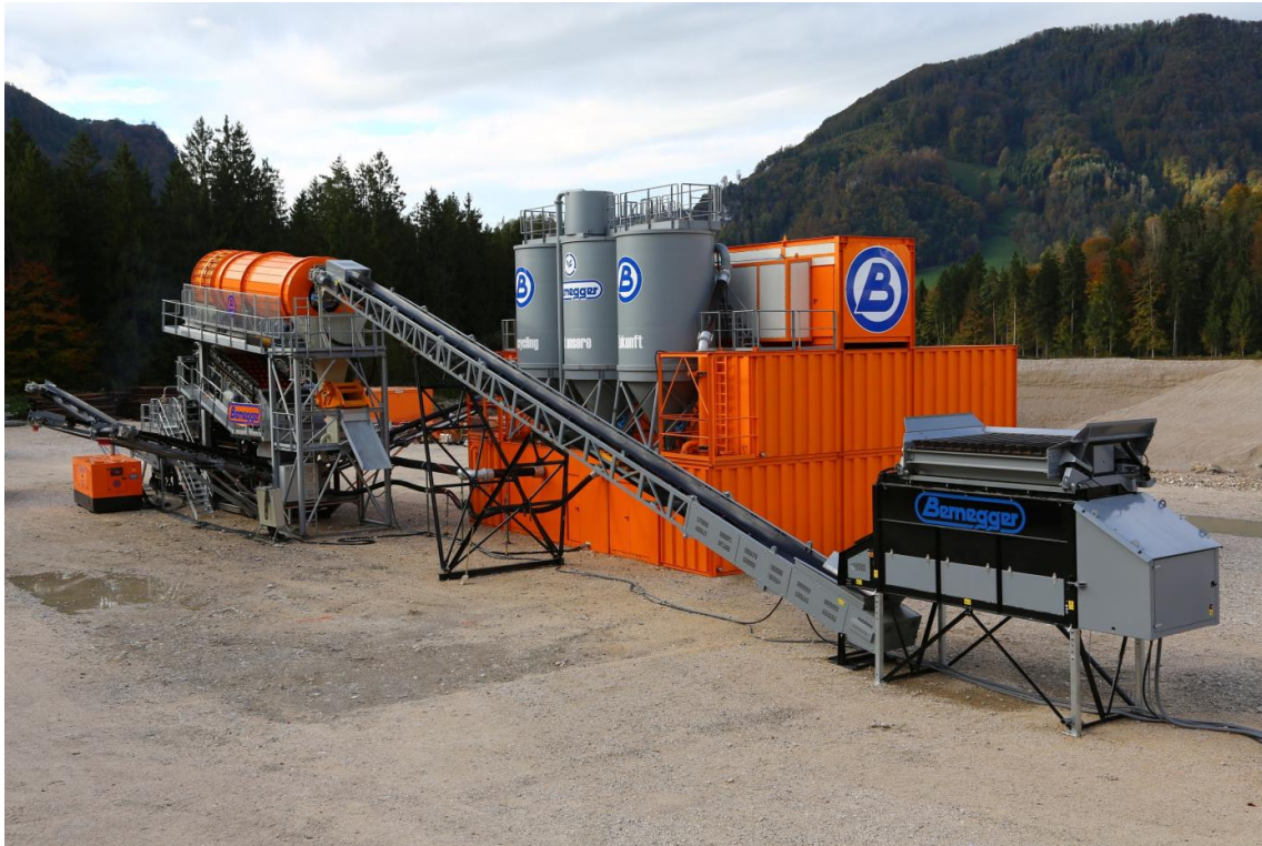
Bild 2: Containermobile Nasssiebanlage zur Boden- und Baurestmassenaufbereitung der Fa. Bernegger. Foto: Fa. Bernegger
